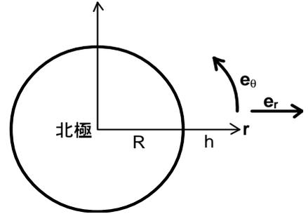
$$m\vec{a} = -mg\vec{e}_r - 2m\vec{\omega} \times \vec{v} + m\omega^2 r\vec{e}_r$$
